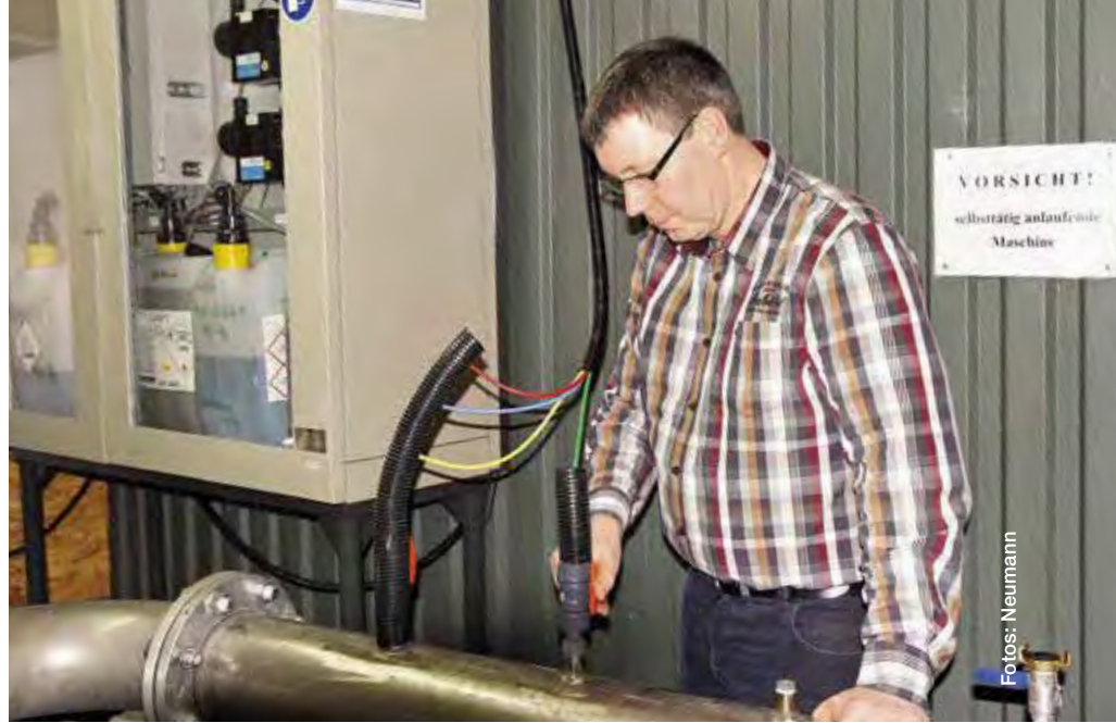
Josef Benning hat eine Flüssigfütterung nachgerüstet, die die angemischten Rohstoffe in den Fermenter pumpt. Die Enzympräparate werden in die Rohrleitung dosiert.
